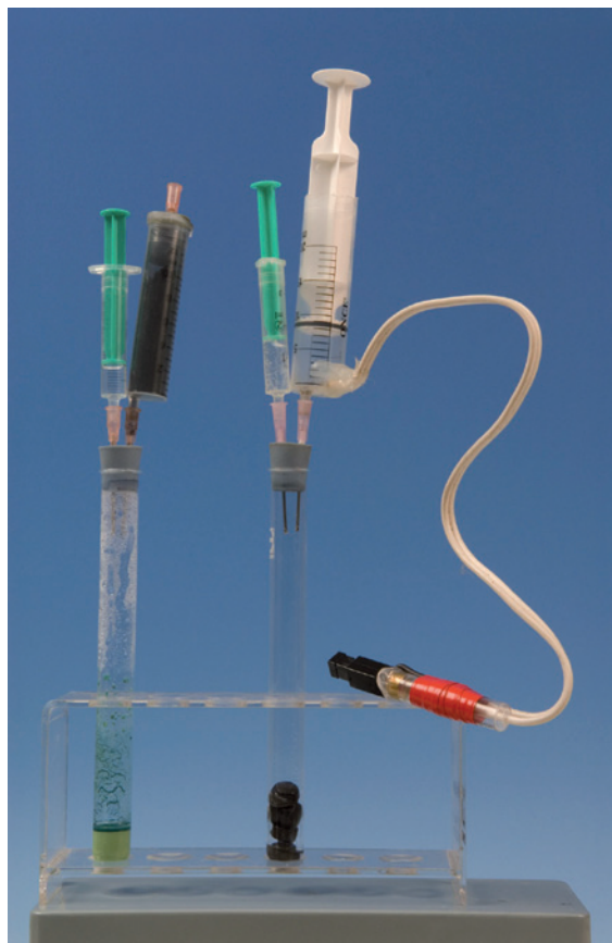
Abbildung 19: Gefährliche Explosionen bei HCN-Begasungen von Gebäuden gegen Anobien lassen sich mit der Low-Cost- Kanone model- lieren.
