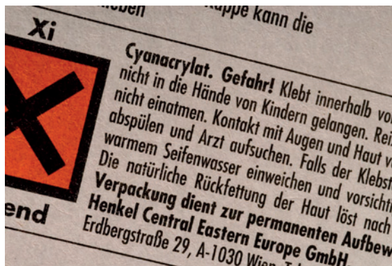
Abbildung 12: Cyanacrylat-Kleber: 2-Cyanoacrylsäuremethyl-ester-moleküle polymerisieren durch Spuren von Hydroxid aus der Luftfeuchtigkeit.
