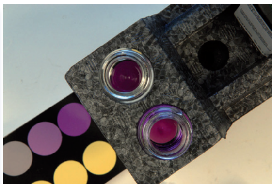
Abbildung 15: Visueller Vergleich der gebildeten Farbe der Messlösung mit den Farbfeldern einer Farbkarte.
