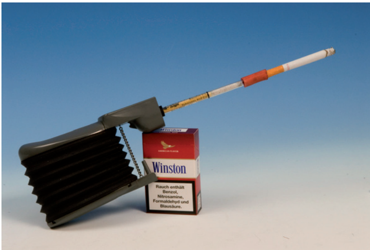
Abbildung 7: Stark vereinfachte Messung von Blausäure im Hauptstromrauch mit Dräger-Röhrchen und Gasspürpumpe (siehe „Experimentelles“).
