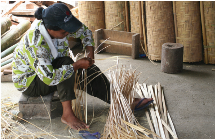
Abbildung 13: Herstellen von Bambusstreifen für Flechtarbeiten.
