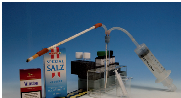
Abbildung 3: Auf Low-Cost getrimmte Apparatur zur nasschemischen Untersuchung des Zigarettenrauch-Hauptstroms aus einem österr. Schulbuch (1. Auflage 1990 [30,31]). Formaldehyd, Stickoxide, aber auch Blausäure sind nach Absorption in H 2 O zum Beispiel mit Aquaquant-Reagenzien nachweisbar (s. „Experimentelles“).
