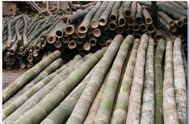
Abbildung 4: Grüner Bambus in Basis-, Mittel- und Spitzenabschnitt.
