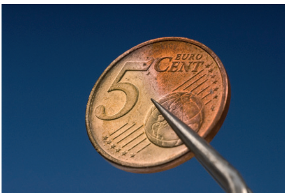
Abbildung 22: Zur Hälfte vergoldete 5-Cent-Münze. Die verkupferte Oberfläche bildet eine ideale Basis für die elektrolytische Vergoldung innerhalb einer Minute.
