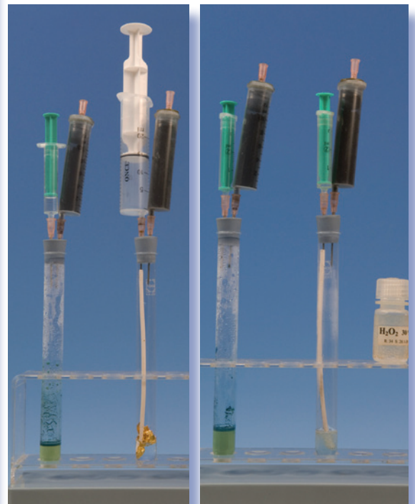
Abbildungen 20 und 20a: Cyanid-Laugerei im Reagenzglas: HCN eingeleitet in NaOH bildet NaCN; Cyanid löst Blattgold im oxidativen Milieu (nach Zusatz von \text{H}_2\text{O}_2 ).
