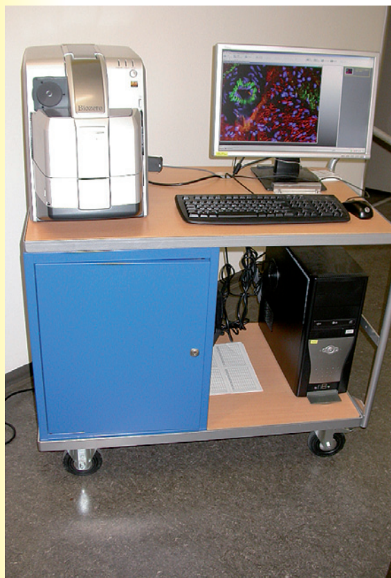
Abb.1: mobiler Aufbau des BZ-8000. Das Fluoreszenzmikroskop steht mit Monitor, Computer und Beamer auf einem Rollwagen und kann so sehr einfach in jedes Labor oder Praktikum gestellt werden.
