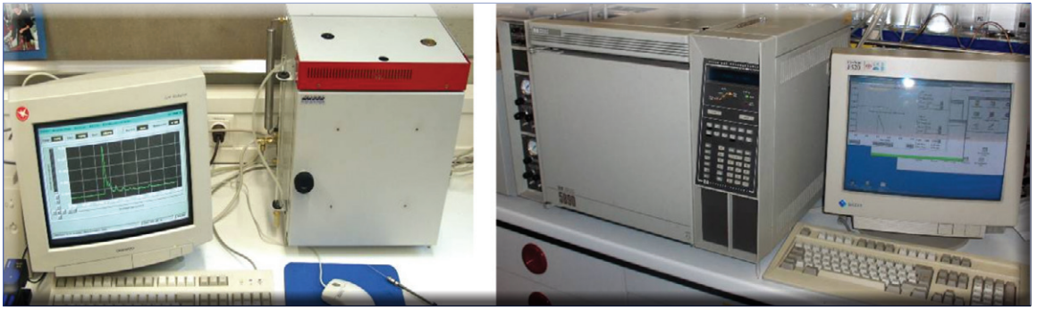
Abbildung 2 (oben): links: Gaschromatograph mit FID, Schulgerät; rechts: GC/MS-Gerätekombination, Uni Marburg.
