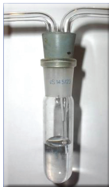
Abbildung 5: Apparatur zum Durchspülen von Me 2 S-Dämpfen und MeSH durch eine Absorberflüssigkeit.
