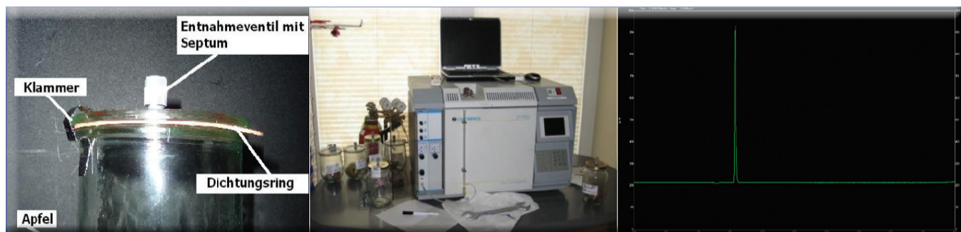
Abbildung 7: Probenvorbereitung: Präpariertes Einmachglas (links), Gaschromatograph mit FID im Zimmer meines Bruders (mitte), typisches Gaschromatogramm (rechts). Glücklicherweise ist der „Ethenpeak“ nach dem Einspritzpeak nahezu der Einzige.
