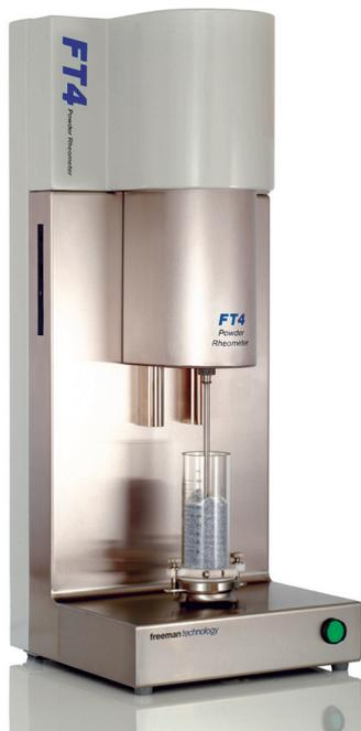
zelle ist ein Modul, das die Schertestmöglichkeiten mit dem FT4 erweitert und jetzt auch das Testen von Materialien ermöglicht, bei denen nur geringe Probenmengen vorliegen. Dazu gehören viele pharmazeutische Wirkstoffe und Materialien wie Medikamentenzubereitungen im frühen Entwicklungsstadium, bei denen an geringen Stoffmengen eine Vielzahl von Tests durchgeführt werden müssen.
