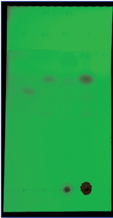
Abbildung 8: Original-Laufmittel, Detektion mit UV 254: Von links nach rechts: Cumarin-Standard, Zimtaldehyd-Standard (mit einer Spur Zimtsäure darunter), Zimt aus Zimt-Kapsel, Zimt-Pulver-Extrakt.
