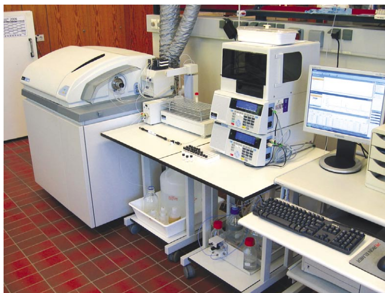
Abbildung 1: ELAN 6100 mit HPLC-Kopplung im Betriebs- und Forschungslabor des Zweckverbands Bodensee-Wasserversorgung.
