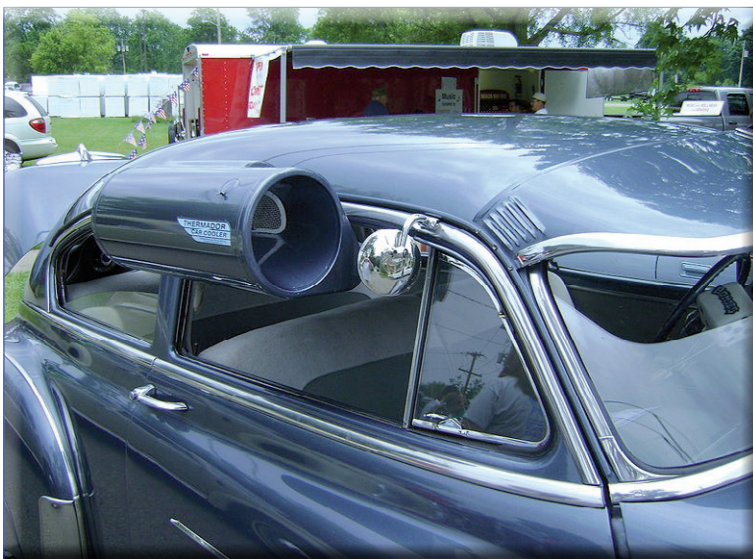
Ein Bild aus den Anfängen der Auto-Klimaanlagen: US-amerikanischer Verdunstungskühler der 1950er Jahre, außen am Fahrzeug montiert (Foto: Doug Coldwell).
