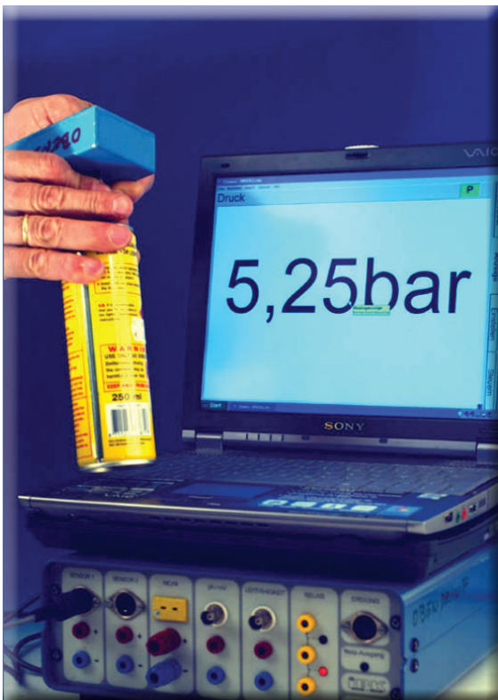
Abbildung 13: Druckmessung in der Dose mittels Sensor und Interface.
