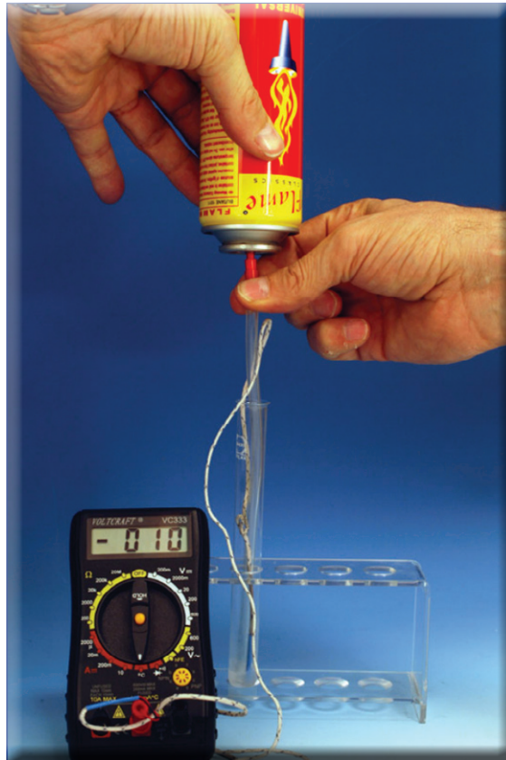
Abbildung 11: Entnahme von Feuerzeuggas, Ermitteln der Siedetemperatur.
