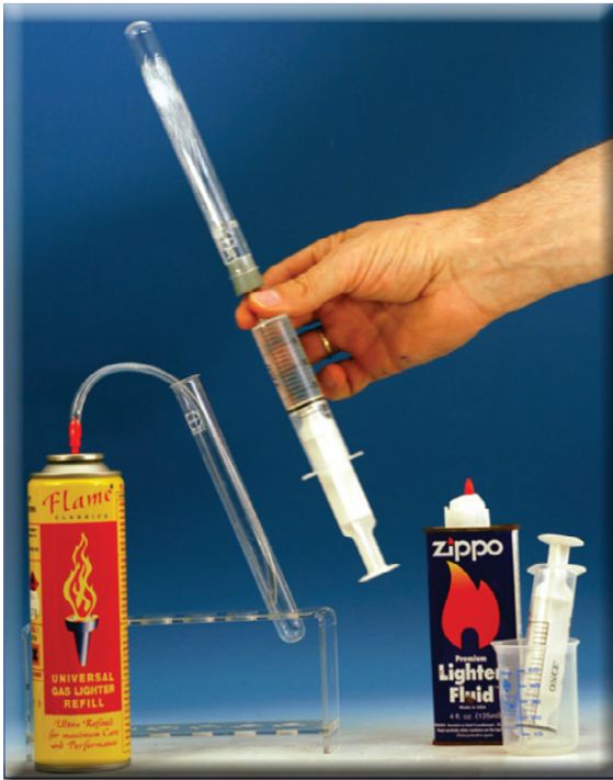
Abbildung 16: Der Feuerzeuggas-Springbrunnen mit Feuerzeugbenzin als Lösungsmittel funktioniert mehrmals hintereinander ohne das Lösungsmittel erneuern zu müssen.
