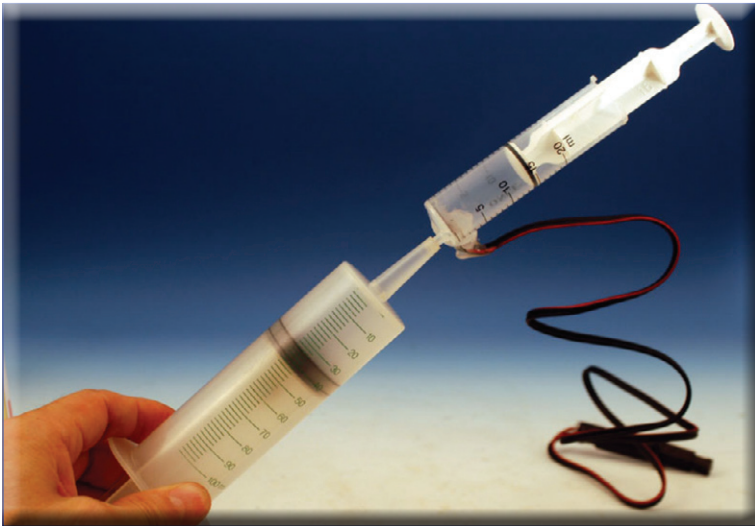
Abbildung 17: Umfüllen von Lachgas in die Low-Cost-Kanone (20 mL-Spritze mit eingeschmolzenen, blanken Kabelenden und angeschlossenem Piezozünder).
