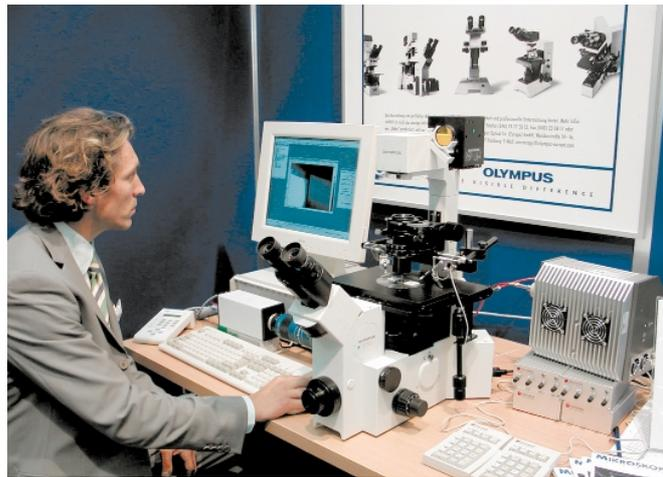
Laut Dr. Helge Schmidt ist das TILLVISION-System beispielsweise geeignet, den Calciumstoffwechsel in Zellen zu untersuchen (rechts der Monochromator, am Mikroskopische die spezielle Patch-Clamp-Anordnung mit Mikromanipulatoren).
