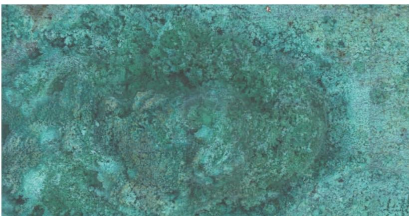
Abb. 3: Malachitstruktur im korrodierten Kupferrohr, Originalgröße 11,11 × 8,65 mm, Gesamthöhe 4,6 mm
