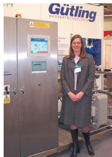
Tanja Löhe, European Pharmaceutical Market Manager von Vivendi Water Systems zeigte die industrielle Anlage von Gütling, mit dem erstmals pharmazeutisches Reinstwasser auch als Heiswasser sanitisierbar ist. Reinstwassersysteme für den Laborbereich bietet die Tochterfirma Elga an.
