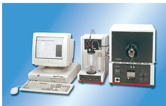
Abbildung 3: CS30HT-Coulometer der Firma Behr, Düsseldorf, zur Gesamt-Schwefelbestimmung in Feststoffen und Flüssigkeiten.
