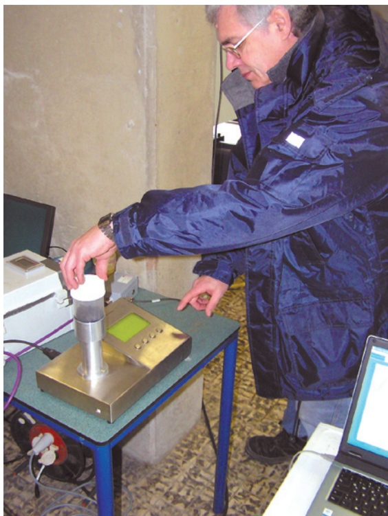
Abbildung 2: Mit dem Mikrowellen-Labormessgerät wird die Laborfeuchtemessung für einen schnellen TS-Messwertvergleich durchgeführt.
