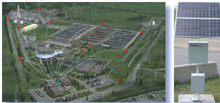
Odotech-Frankreich-Direktor Philippe G. Micone (li.) rechnet mit einer rasant steigenden Installationsbasis für die Odowatch-Systeme. Das Foto oben Mitte zeigt ein solches System für eine Kläranlage. Es besteht aus zehn elektronischen Nasen (rote Punkte sowie Foto rechts; beide Fotos Odotech), die drahtlos ihre Messwerte an eine Zentrale (grüner Punkt) funken. Ein Programm berechnet daraus sowie aus den aktuellen Werten der Wetterstation (blauer Punkt) die aktuelle Geruchsausbreitung.
