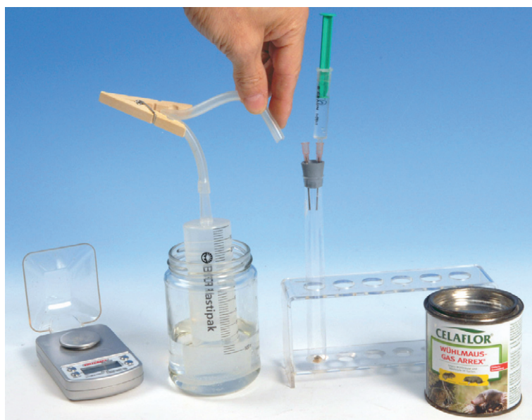
Abbildung 8: Volumetrische Bestimmung des Carbid-Gehaltes im „Wühlmauspräparat“ (ca. 80%ig). Das geringe Totvolumen des Gasentwicklers und die Kalibrierung der 100mL-Spritze tragen zum sicheren Gelingen des einfachen Experimentes bei.
