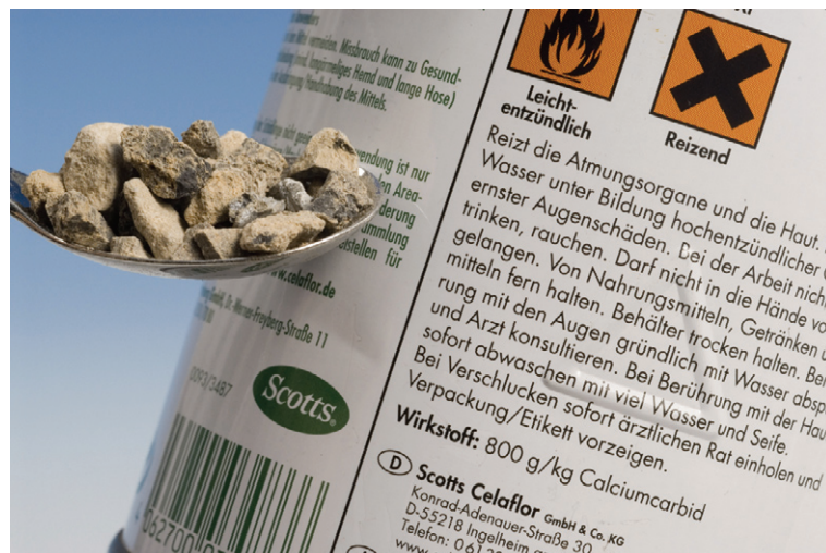
Abbildung 4: Technisch erzeugtes Ca-Carbid hat einen Gehalt von ca. 80% und ist durch Spuren an Eisenoxid und Kohlenstoff braun-schwarz gefärbt.
