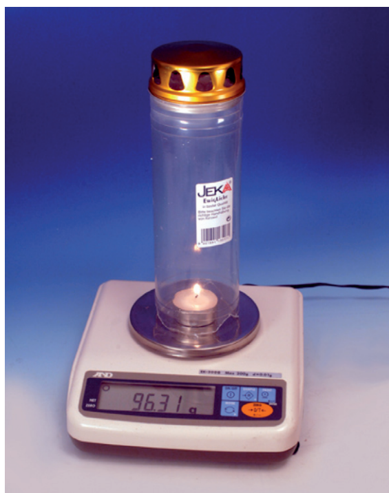
Abbildung 11: Das Teelicht darf nur 3 Minuten brennen. Dann werden die Verbrennungsprodukte von Ätznatron großteils absorbiert.
