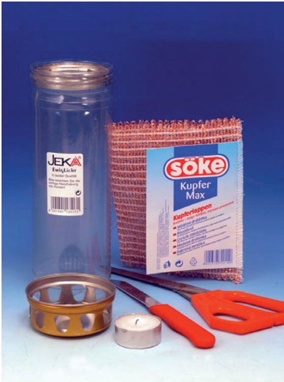
Abbildung 7: Die Materialien: 20,5 cm hohes Jeka Ewiglicht mit Metallring und Windschutz, Paraffin entfernt, Kupferlappen, Teelicht, Schere, scharfes Labormesser.
