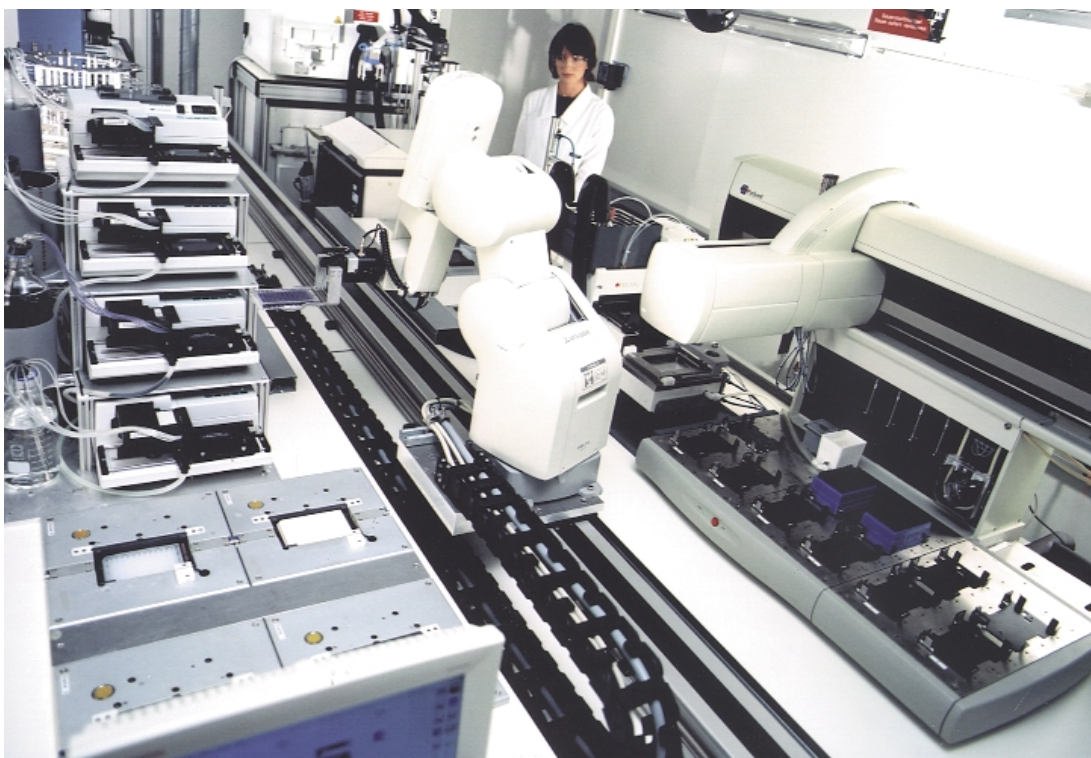
Die hier gezeigte, robotergestützte Screening-Anlage kann bis zu 50 000 Proben pro Tag testen. Dabei wird untersucht, ob sich Enzyme als Biokatalysatoren für chemische Synthesen einsetzen lassen (Fotos: BASF).
