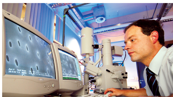
Abbildung 6: Dentinplättchen werden mit einem Elektronenmikroskop untersucht.
