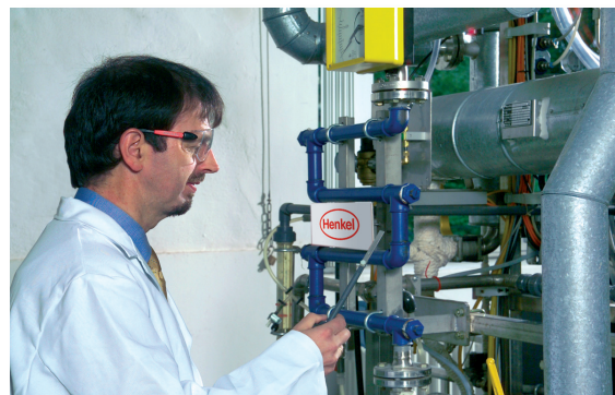
Abbildung 4: Die Testmethode für einsetzende Biofilmbildung wird im Technikum in Kühlkreisläufen erprobt. Edelstahlstreifen, an Bypass-Stellen eingesetzt, werden auf eine Schleimschicht überprüft.
