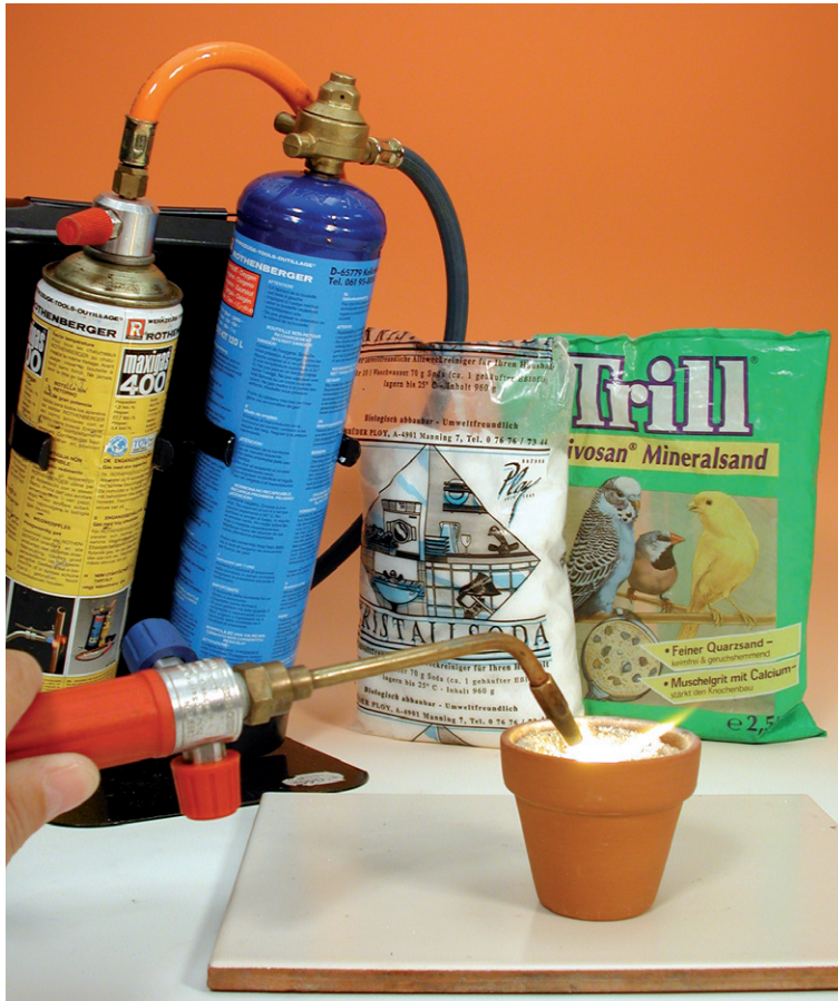
Abbildung 2: Aufschmelzen der wasser- freien Soda im Blumentopf.
