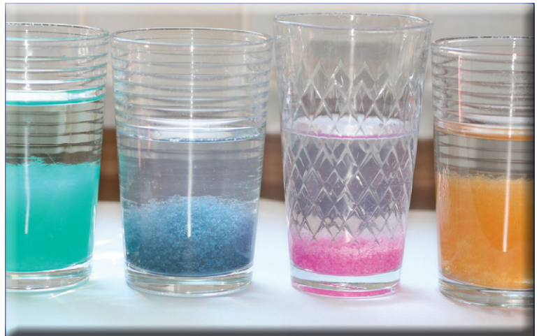
Abbildung 8: Superabsorbentern mit Metall-Ionen: \text{Cu}^{2+} , \text{Cr}^{3+} , \text{Co}^{2+} , \text{Fe}^{3+} .
