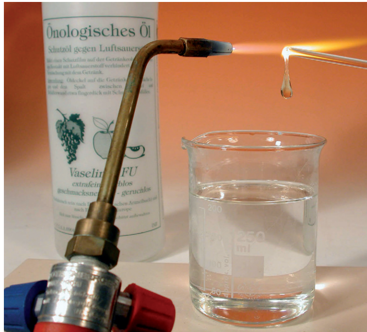
Abbildung 8: Die Vorspannung einer Glasträne wird erzeugt durch das Tropfen in ein Glas mit einer Paraffin-Wasserschichtung.
