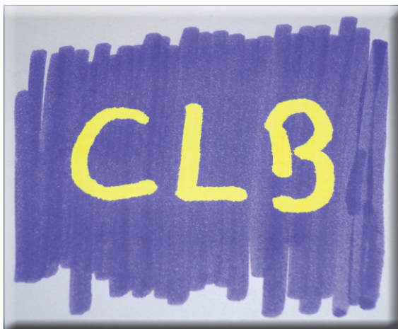
Abbildung 12: Violette Farbe eines selbst hergestellten Fasermalers, die mit einem Tintenlöschstift übermalt wurde.
