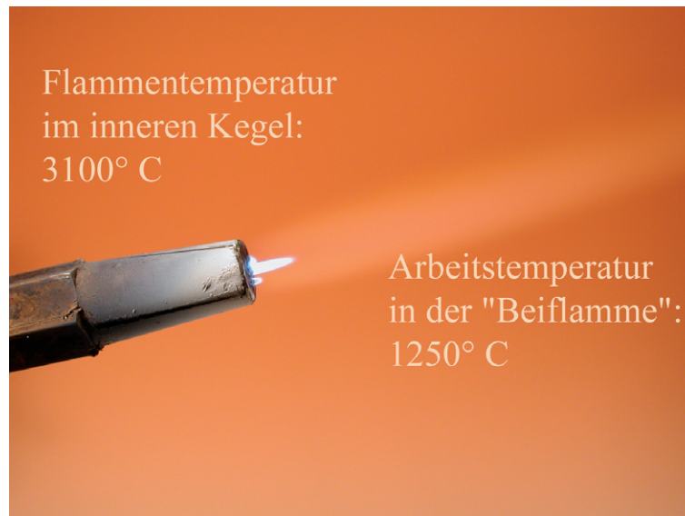
Abbildung 1: Temperaturverteilung in der Flamme des Miniatur-Schweißbrenners.
