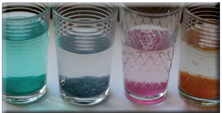
Abbildung 9: Superabsorbentern mit Metall-Ionen nach NaCl-Zugabe: \text{Cu}^{2+} und \text{Co}^{2+} gehen bei Raumtemperatur etwas in Lösung.
