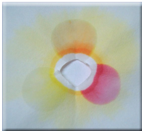
Abbildung 7: Ausschnitt aus dem Papierchromatogramm des grünen Herlitz-Stiftes mit aufgetropften Pufferlösungen (links pH 7-, Mitte pH 8- und rechts pH 9-Pufferlösung).
