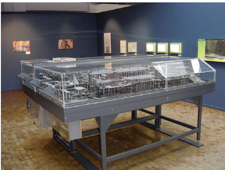
Abbildung 9: Nachbau der Zuse Z1, eines mechanischen Rechners, im Deutschen Technikmuseum in Berlin. Ein Mangel dieses Rechners war das Verhaken der mechanischen Schaltglieder im Betrieb (Foto: ComputerGeek).
