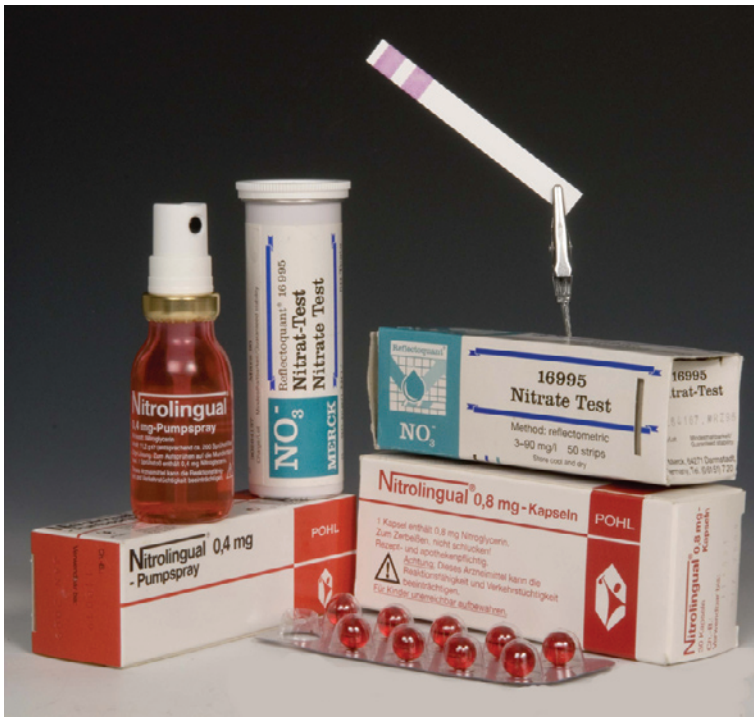
Abbildung 11: Der in der Schule bestens bekannte Nitrat-Test (Reflectoquant) eignet sich zum Nachweis des Wirkstoffes NO in Nanomol-Mengen in Nitrolingual (Foto: Obendrauf).
