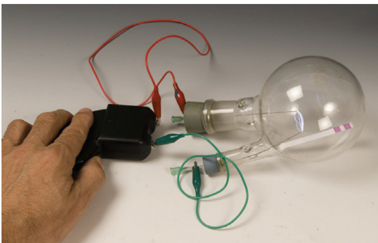
Abbildung 9: Kurze Blitze führen bereits nach wenigen Sekunden auf den feuchten Reaktionszonen zu Farbstoffkupplung – NO bzw. NO x ist nachgewiesen (Foto: Obendrauf).
