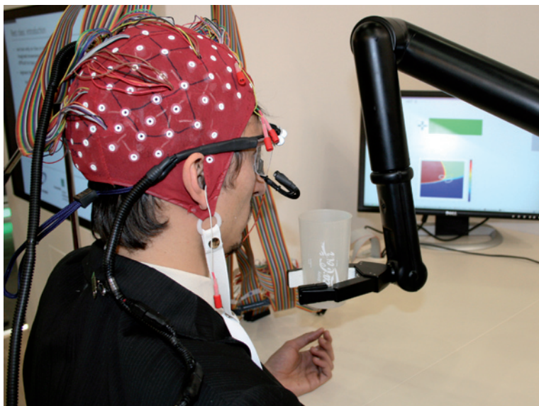
Abbildung 25: Siamac Fazli, Doktorand am FIRST, kann mit seinen Gedanken über eine nicht-invasive Hirnstromableitung einen Robotarm steuern und damit beispielsweise einen Becher an den Mund heben. Ein Eyetracker verfolgt, wohin der Proband sieht; ein Headtracker ermittelt die Kopfstellung. Die Darstellung auf dem Bildschirm ermöglicht zweidimensional eine Cursorsteuerung und darüber die Bewegungsauswahl für den Robotarm (Foto: RK).
