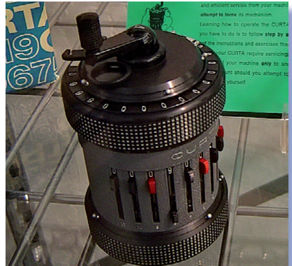
Abbildung 8: Kurbeln und Walzen als Auslaufmodell: Die Curta ist eine mechanische Rechenmaschine. Sie arbeitet mit „doppelten Staffelwalzen“ und ist noch immer die kleinste serienmäßig hergestellte mechanische 4-Rechenarten-Rechenmaschine der Welt. Sie konnte ursprünglich bis zu elfstellige, später fünfzehnstellige Ergebnisse liefern. Sie wurde von dem österreichischen Büromaschinenfabrikanten Curt Herzstark konstruiert (daher der Name). Herzstark beendete die Konstruktionspläne im KZ Buchenwald. Sie war zu ihrer Zeit eine technische Sensation. Produktionsstart war im Oktober 1948 (Foto: Calton).
