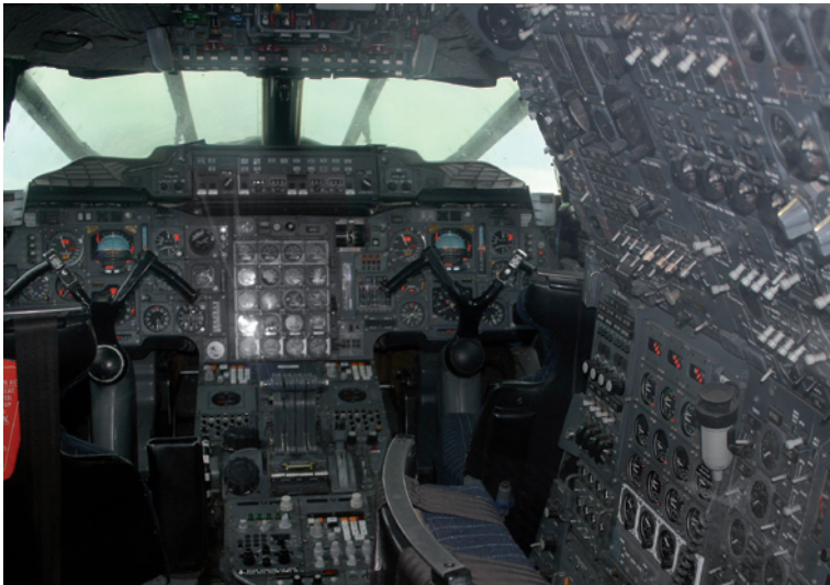
Abbildung 10: Blick in das Cockpit der Überschall-Passagiermaschine Concorde (Erstflug des Prototyps 1969, letzter Flug 2003). Taster und Schalter bestimmen zusammen mit Analoginstrumenten das Bild. Für die Triebwerkssteuerung gab es zwar noch Hebel; die Kommandoübertragung an die Stellglieder erfolgte jedoch elektrisch: Die Concorde war das erste Verkehrsflugzeug mit „Fly-by-wire“-Steuerung. Von Computern und Bildschirmen keine Spur (allerdings hatte die Concorde schon einen Digitalcomputer für Navigationsdaten; Foto: RK).
