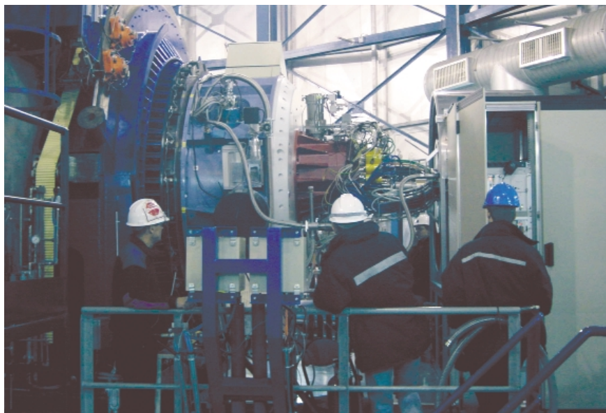
Die neue Kamera am VLT. Links erkennt man den blauen, einem Zahnrad ähnlichen Anschlussflansch. In der Mitte befindet sich die adaptive Optik „Naos“ (hellblau) und rechts „Conica“ (rot); Foto: MPIA).
