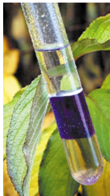
Abb.5: Ungewöhnliches Lösungsverhalten einiger ionischer Flüssigkeiten; hier ein Dreiphasengemisch, bestehend aus: ionischer Flüssigkeit (unten), Wasser mit Farbstoff (mitte) und Cyclohexan (oben).
