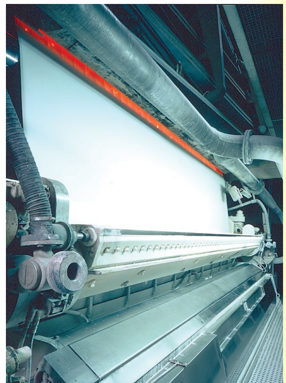
Abbildung 5: Streichen von Papier mit Infrarot-Trocknung.
