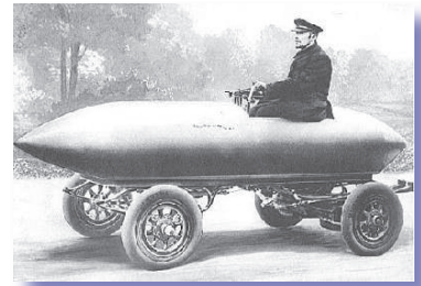
105 km/h schnell, 1450 kg schwer: E-Mobil „la Jamais Contente“ mit dem belgischen Rennfahrer Camille Jenatton (Abb.: CLB-Archiv).
