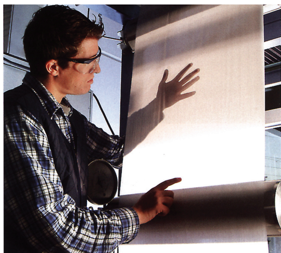
Die Herstellung der Separion-Folie erfolgt in einem kontinuierlichen Prozess, bei dem ein hauchdünnes Vlies keramisch beschichtet wird. Neben dem menschlichen Auge wird die Qualität über optische Inspektionssysteme kontrolliert (Foto: Degussa).
