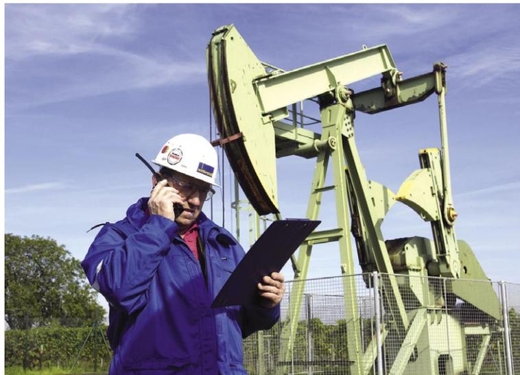
Lässt der Eigendruck in der Lagerstätte nach, wird das Öl mit Pferdekopfpumpen aus der Tiefe gefördert
