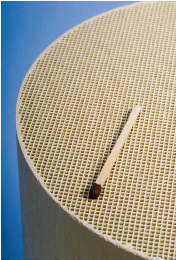
Abbildung 5: Eine technologische Herausforderung ist die Herstellung der Vollextrudate aus katalytischem Material mit einer Zelldichte von 300 cpsi.
