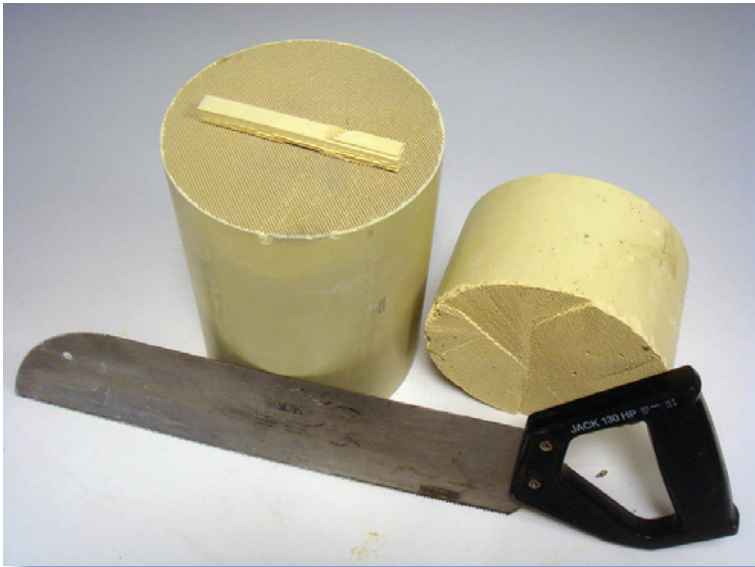
Abbildung 10: Fabrikneue SCR-Katalysatoren, die bei der Endkontrolle durchgefallen, eignen sich ausgezeichnet für schulische Zwecke.
