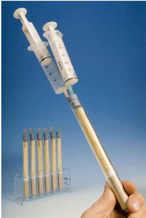
Abbildung 13: Nach dem Erhitzen des Reagenzglases im Bereich des darin befindlichen Katalysators werden die zwei mit je 10 mL \text{NO}_x bzw. \text{NH}_3 gefüllten Spritzen aufgesetzt. Zuerst werden die 10 mL \text{NO}_x in die Keramik gedüst, dann schiebt man aus der anderen Richtung \text{NH}_3 dazu. Nach mehrmaligem Richtungswechsel haben \text{NO}_x und \text{NH}_3 nachweislich gemäß den Gleichungen (4) und (5) reagiert.
