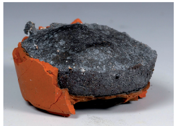
Abbildung 13: Phosphidhaltige Schlacke nach der Umsetzung von Tricalciumphosphat mit Al-Pulver, Initialzündung mit Thermitgemisch.
