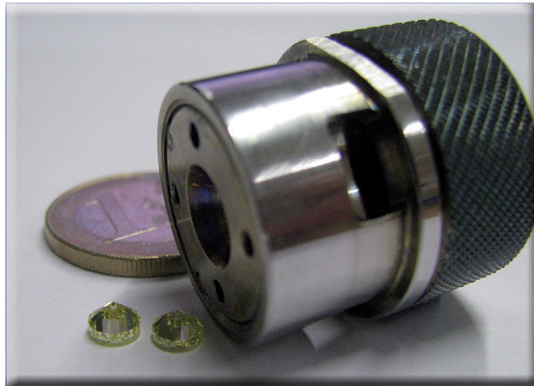
Der Diamantamboss – das Herzstück der Anlage, in der in einer kleinen Kammer extrem hohe Drücke zwischen zwei Diamantenspitzen entstehen.
